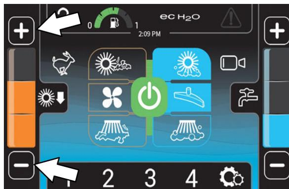
3. Use o *botão de aumento da solução (+)* e o *botão de diminuição da solução (-)* para definir o nível do fluxo da solução em uma determinada zona.
