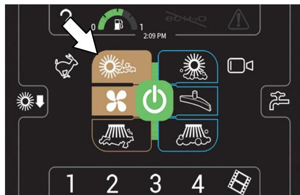
*OBSERVAÇÃO: O modo de varrição e o modo de lavagem não podem funcionar ao mesmo tempo. O modo de varrição deixará de funcionar e o modo de lavagem começará a funcionar, se qualquer botão de lavagem for pressionado enquanto a máquina estiver no modo de varrição.*
