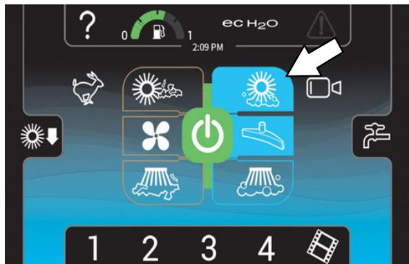
**OBSERVAÇÃO:** O modo de lavagem e o modo de varrição não podem funcionar ao mesmo tempo. O modo de lavagem deixará de funcionar e o modo de varrição começará a funcionar, se qualquer botão de varrição for pressionado enquanto a máquina estiver no modo de lavagem.
