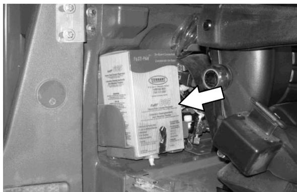
4. Remova as linhas perfuradas para abrir a nova embalagem FaST-PAK. Não remova o saco da embalagem. Retire o conector da mangueira da parte de baixo do saco e remova a tampa da mangueira.
