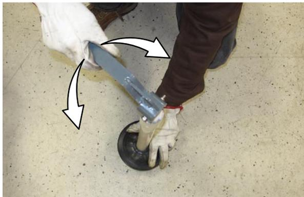
8. Feche a válvula de drenagem variável do tanque de recuperação.
