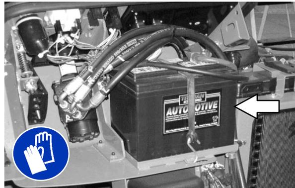
**MEDIDA DE SEGURANÇA:** Ao fazer a manutenção da máquina, evite contato com os ácidos da bateria.
