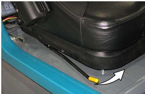
Ajuste: Empurre a alavanca na direção ao assento e deslize o assento para a posição desejada. Solte a alavanca para travar o assento na posição.
