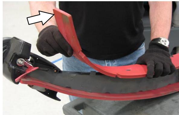
13. Instale a nova lâmina do rodo dianteiro ou gire o lâmina existente para usar outra borda. Certifique-se de que todos os furos da lâmina do rodo estejam ajustados nas guias.
