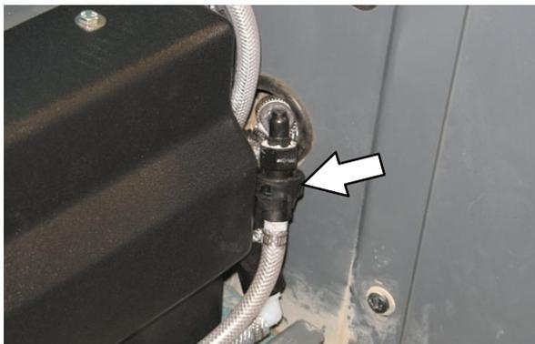
5. Coloque a mangueira de entrada do sistema do ec-H2O em um recipiente contendo 19 litros de vinagre branco ou de arroz. Coloque a mangueira de saída em um tanque vazio.
