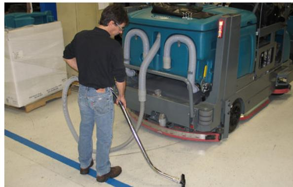
8. Após aspirar, pressione o botão do aspirador/rodo para desligar o aspirador. A luz acima do botão será apagada.
