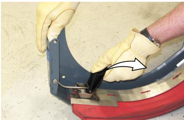
4. Remover os rodos, espaçador e receptáculo do para-choques do rodo.
