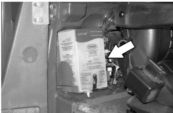
**OBSERVAÇÃO:** Não use o sistema FaST ou ec-H2O se o tanque de solução contiver detergentes de lavagem convencional. Drene, enxágue e encha novamente o tanque de solução com água limpa e fresca antes de operar o sistema FaST ou ec-H2O. Detergentes de limpeza convencional podem causar falha no sistema FaST/ec-H2O.
