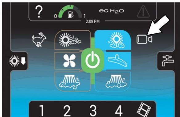
A câmera liga automaticamente quando a parte inferior do *pedal direcional* é colocada na posição de ré e permanece ligada enquanto a máquina estiver em ré.
