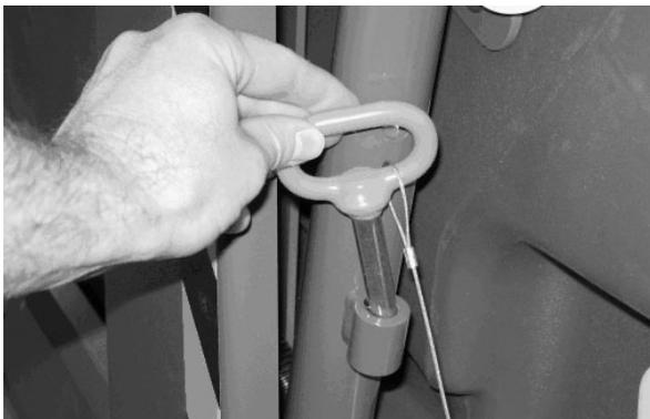
5. Insira o pino de suporte da caçamba em um dos três orifícios de suporte. Rebaixe a caçamba até que ela encoste no pino de suporte.
