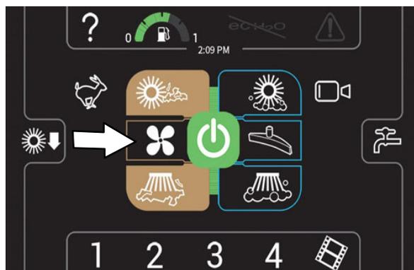
6. Pressione o botão de câmera traseira a qualquer momento para checar a performance de limpeza atrás da máquina.
