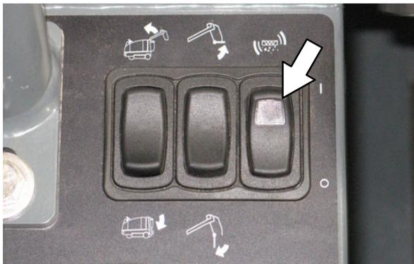
3. Depois que a vibração do filtro parar, pressione e segure a parte de cima do *interruptor de elevação/rebaixamento da caçamba* para elevar a caçamba. Solte o botão quando a caçamba estiver na posição desejada.
