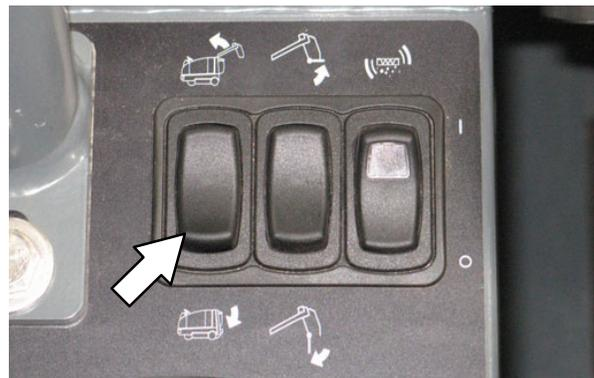
**AVISO:** Ponto de prensamento no braço de elevação. Mantenha-se afastado dos braços de elevação da caçamba.
