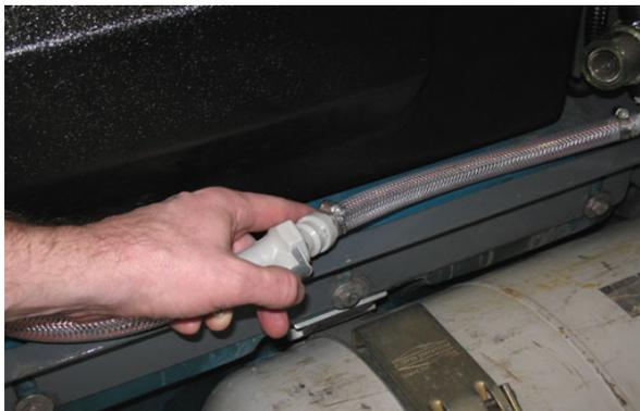
4. Desconecte a mangueira de saída do sistema do ec-H2O da mangueira para o cabeçote de lavar e conecte a mangueira de enxágue de saída (conector preto) para a mangueira de saída do sistema do ec-H2O.
