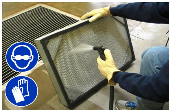
**OBSERVAÇÃO:** Caso use água para limpar o filtro de poeira, certifique-se de que o filtro esteja totalmente seco antes de reinstalá-lo na caçamba. **Nunca** reinstale um filtro úmido.
