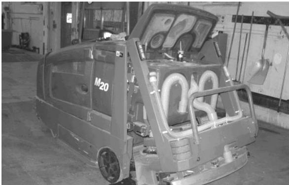
**MEDIDA DE SEGURANÇA:** Antes de abandonar a máquina ou fazer sua manutenção, pare numa superfície plana, acione o freio de estacionamento e retire a chave.
