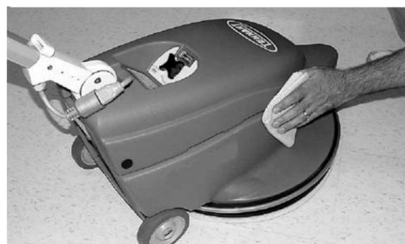
4 - Limpe o cabo de alimentação com um pano úmido e detergente neutro. Enrole cuidadosamente o cabo ao redor do gancho. Substitua o cabo se estiver danificado.
