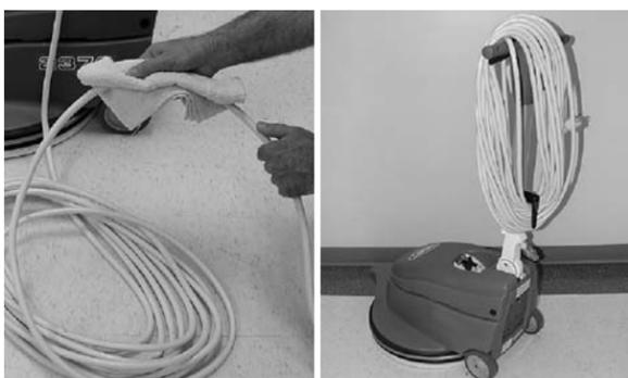
5 - Armazene a máquina em uma área seca com a alça posicionada para cima ou dobrada para baixo.
