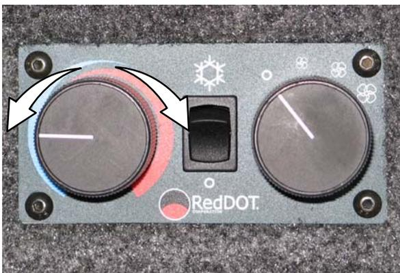
Use o *botão do ventilador* para controlar a velocidade do ventilador. Este botão afeta o aquecedor e o condicionador de ar.
