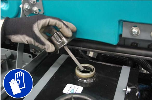
Uma tampa de enchimento está montada no topo do reservatório. Ela possui um respiradouro embutido e um indicador de nível de óleo. Troque a tampa a cada 800 horas de operação.
