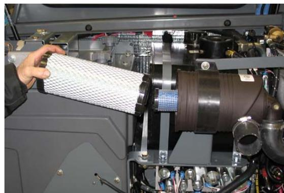
Troque o elemento de segurança do filtro depois que o filtro primário for trocado três vezes. Não retire o elemento de segurança do filtro do compartimento, a menos que ele restrinja o fluxo de ar.
