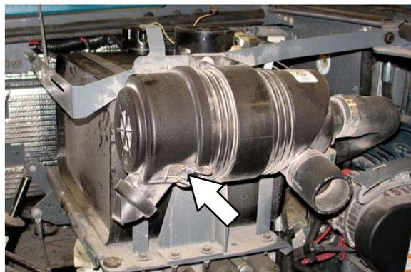
Remova o elemento do filtro. Limpe cuidadosamente a tampa terminal e a parte interna do alojamento com pano úmido. Limpe as superfícies de vedação do alojamento.
