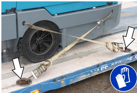
**MEDIDA DE SEGURANÇA:** Use um guincho ao descarregar a máquina de um caminhão ou trailer. Não remova a máquina do caminhão ou trailer a menos que a carga esteja a 380 mm ou menos do chão.
