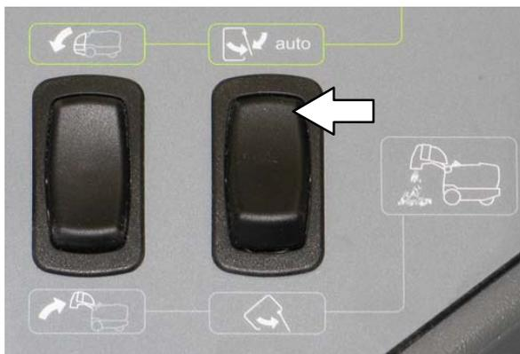
5. Selecione a velocidade do motor. Use a velocidade média para varrição em geral e velocidade alta para varrições leves.
