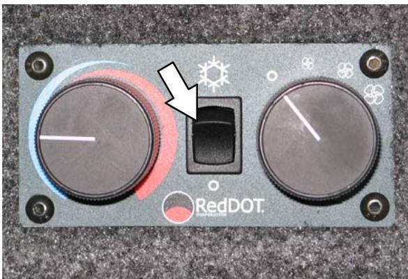
Use o *botão de temperatura* para controlar a temperatura de aquecimento da cabine. Use o *botão do ventilador* para controlar a temperatura do condicionador de ar.
