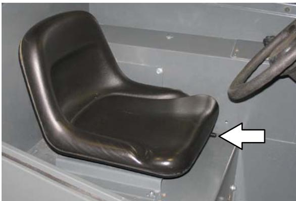
Use o controle de ajuste de peso para firmar o assento do operador. Consulte o indicador ao lado do controle de ajuste de peso para ajudá-lo a determinar se o assento está firme.
