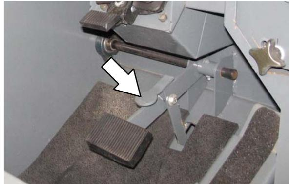
**PEDAL DE INCLINAÇÃO DA COLUNA DE DIREÇÃO**
