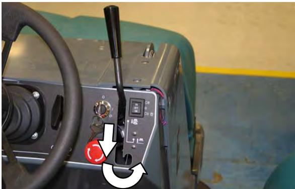
2. Coloque a alavanca da escova principal na posição à esquerda **Escova principal levantada e desligada**.
