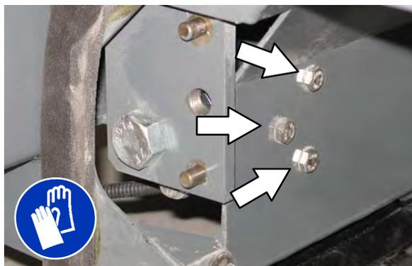
3. Mova o suporte para cima ou para baixo nas fendas e aperte novamente os parafusos de montagem.
