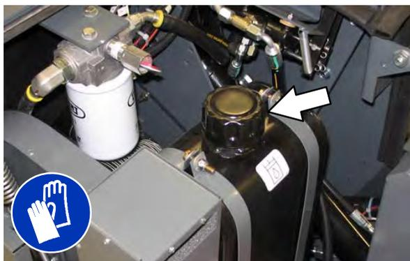
Uma tampa de enchimento está montada no topo do reservatório. Ela possui um respiradouro embutido e um indicador de nível de óleo. Troque a tampa a cada 800 horas de operação.
