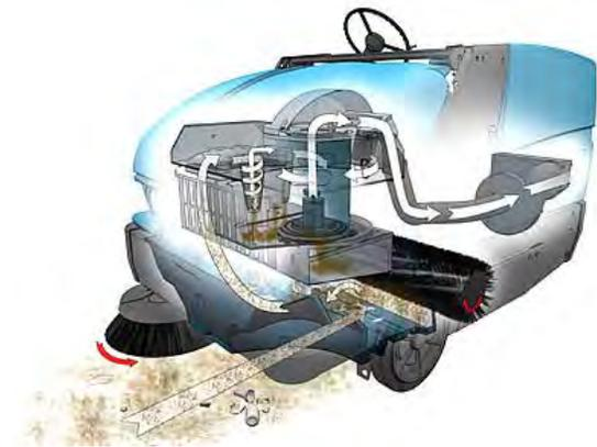
O volante de direção controla a direção em que a máquina é movida. O pedal de direção controla a velocidade e o sentido para frente/reverso. O pedal do freio diminui a velocidade até parar a máquina.
