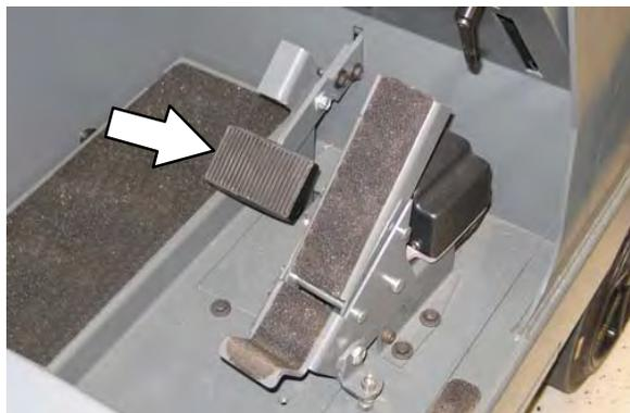
**NOTA:** A máquina anda livremente uma distância curta quando o pé é retirado do pedal de direção. Use o pedal do freio para parar a máquina.
