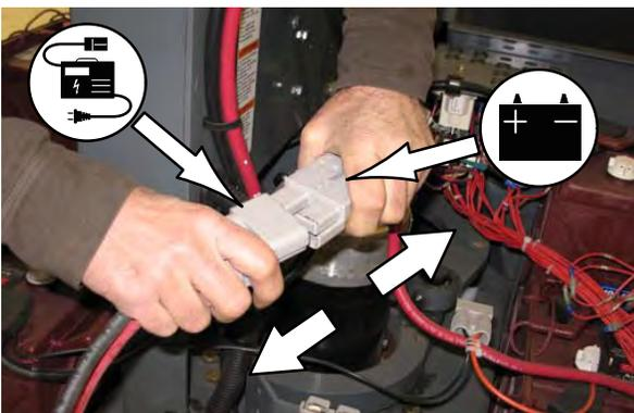
**ATENÇÃO:** Não desconecte o cabo CC do conector da máquina enquanto o carregador estiver funcionando. Isso pode resultar na formação de arcos. Se precisar interromper o carregamento, desconecte primeiro o cabo de alimentação CA.
