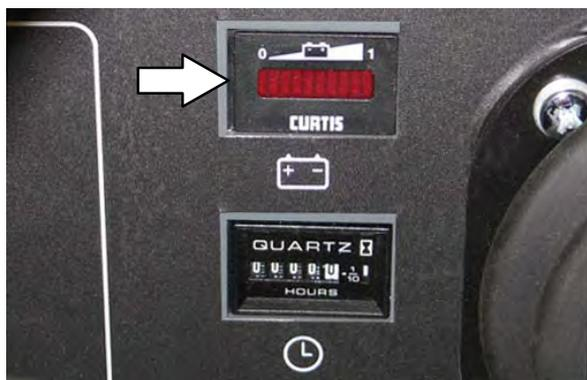
Se as baterias estiverem com carga total, o indicador mais à direita está aceso. Quando as baterias descarregam, o indicador se move ao longo do display para a esquerda. Recarregue as baterias quando o indicador piscar,
