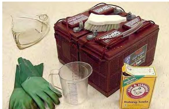
Objetos metálicos podem causar curto-circuito nas baterias. Evite o contato de objetos metálicos com as baterias.
