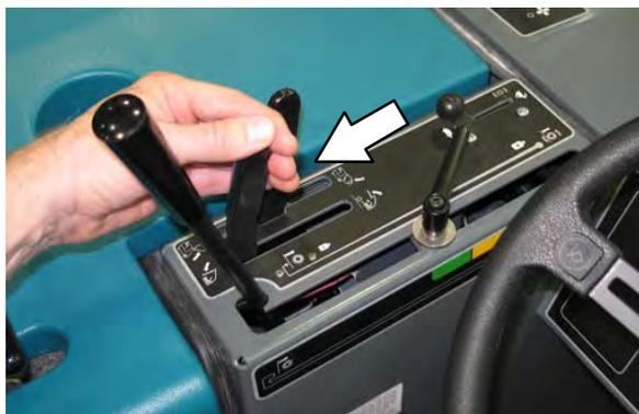
4. Sacuda o filtro de poeira segurando a alavanca do aspirador e de vibração do filtro na posição **Vibração do filtro** durante 30 segundos.
