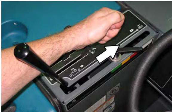
3. Mova a alavanca do aspirador e de vibração do filtro para a posição **Ventoinha do aspirador ligada**.
