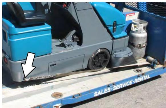
6. Se a superfície de carregamento não for plana ou estiver a mais de 380 mm (15 pol.) do chão, use um guincho para descarregar a máquina.
