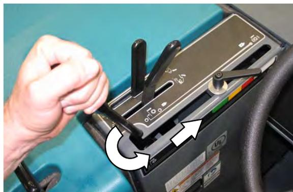
5. Coloque a alavanca da escova lateral na posição à esquerda **Escova lateral rebaixada e ligada**. A escova começa a girar automaticamente.
