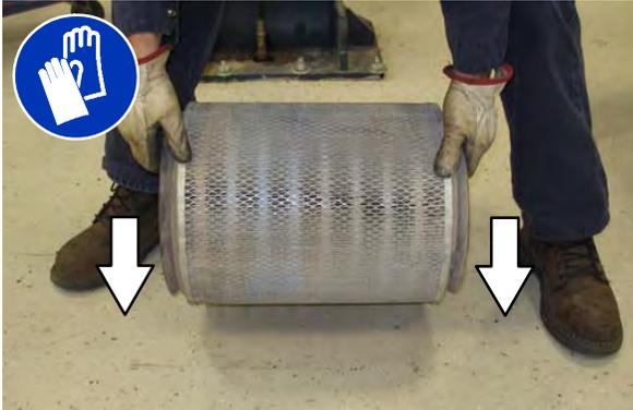
**AR**–Use sempre proteção para os olhos ao usar ar comprimido. Sopre o ar no filtro na direção do centro para fora. Nunca use mais do que 550 kPa de pressão de ar e mantenha o bico sempre a uma distância mínima de 50 mm (2 pol.) do filtro. O bico não deve ter menos de 3 mm (0,13 pol.).
