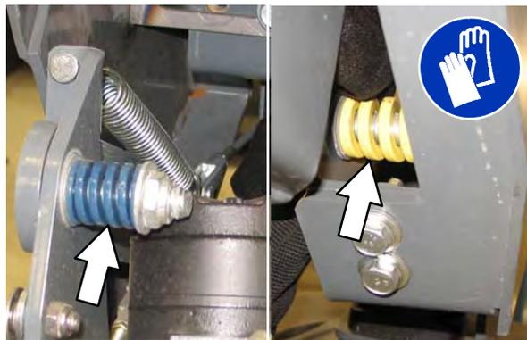
A inclinação lateral da escova lateral (esquerda para direita) é ajustada com dois parafusos.
