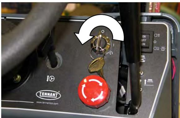
**MEDIDA DE SEGURANÇA:** Antes de sair da máquina ou fazer sua manutenção, pare numa superfície plana, acione o freio de estacionamento, desligue a máquina e retire a chave.
