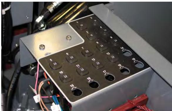
Se a sobrecarga que causou o desarme do disjuntor ainda existir, o disjuntor continuará a interromper o fluxo de corrente até que o problema seja corrigido.
