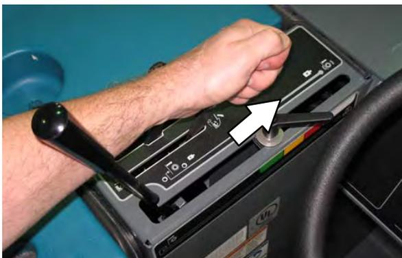
12. Mova a alavanca do aspirador e de vibração do filtro para a posição **Ventoinha do aspirador ligada**.
