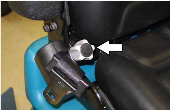
A alavanca permite ajustar a posição do assento para frente e para trás.
