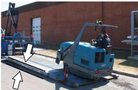
3. Para guinchar a máquina para um caminhão ou reboque, prenda as correias de transporte nos pontos traseiros das barras de amarração. Os pontos traseiros das barras de amarração são os orifícios nos lados da armação da máquina perto do para-choque traseiro.
