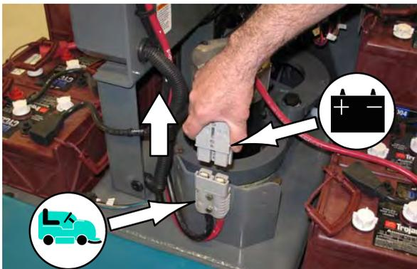
6. Conecte o conector do carregador ao conector da bateria.
