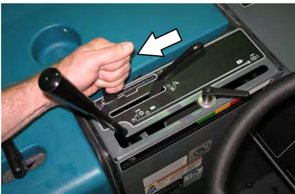
3. Coloque a barra de suporte em sua posição para armazenamento.
