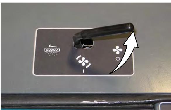
*NOTA: Excesso de calor na caçamba fará com que o Thermo-Sentry movimente a alavanca do aspirador e de vibração do filtro para a posição **Ventoinha do aspirador desligada**. Também fará com que a luz de temperatura da caçamba acenda. Se isso ocorrer, pare a máquina, elimine a fonte de calor e recoloque a alavanca na posição **Ventoinha do aspirador ligada**.*
