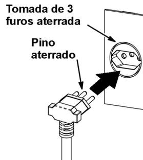
**POR SEGURANÇA:** Não opere a máquina a menos que o cabo esteja adequadamente aterrado. Não opere a máquina com cabo e/ou plugue danificados. Não utilize a máquina com uma extensão.
