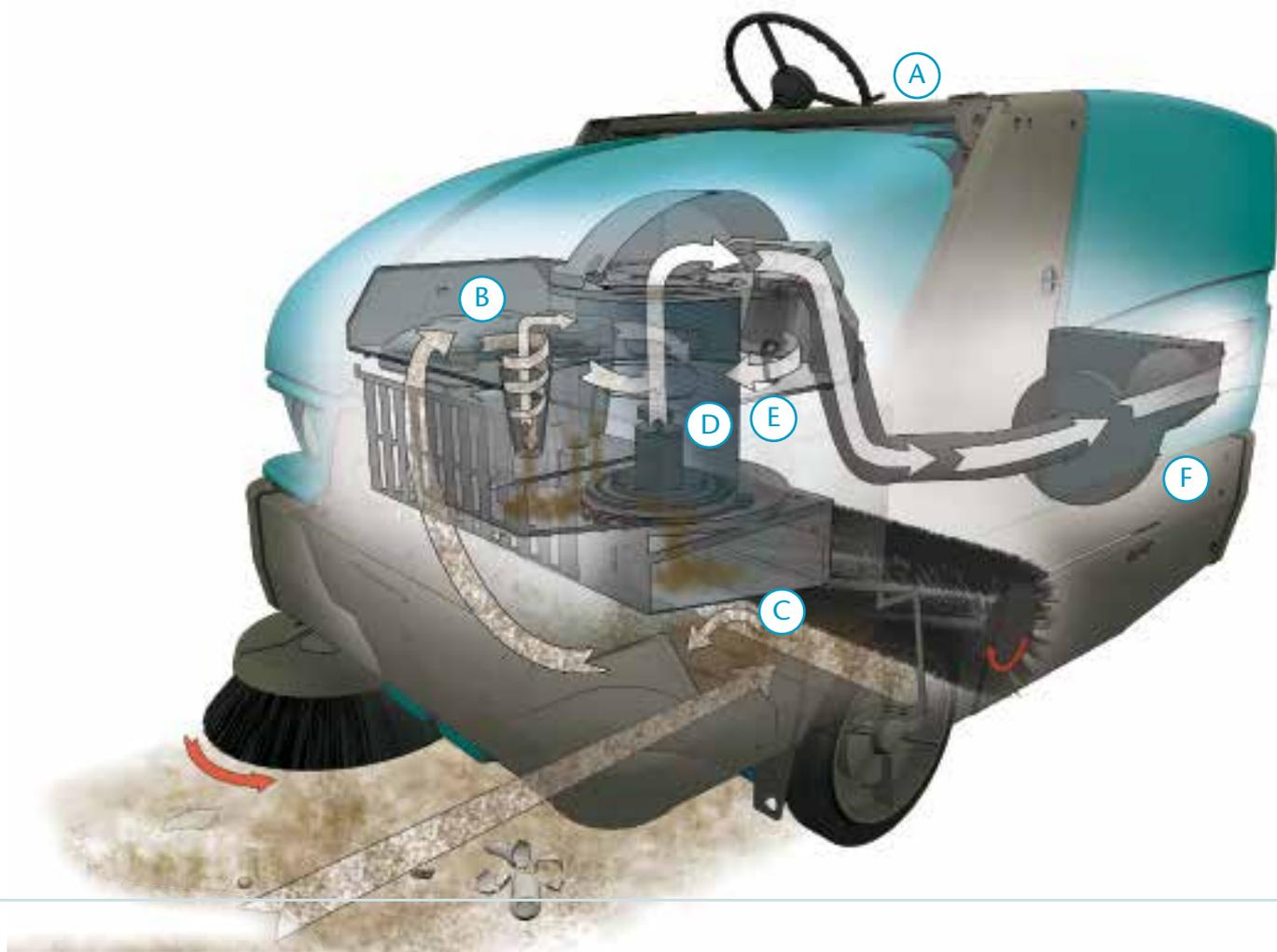
**A** **Compartimento do operador.** Garantia de segurança para o operador, alertando-o e desligando o fluxo de ar se houver um aumento da temperatura da caçamba detectado pelo Thermo-Sentry®.
